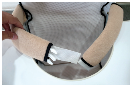
그림29. 1차 PROTOTYPE(착석 보조기기) 벨트 결합
