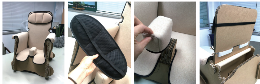
그림19. MOCK-UP(착석 보조기기) 쿠션 제작
