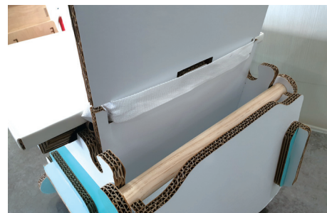
그림29. 1차 PROTOTYPE(착석 보조기기) 벨트 결합
