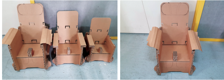
그림18. MOCK-UP(착석 보조기기) 골격구조 제작
