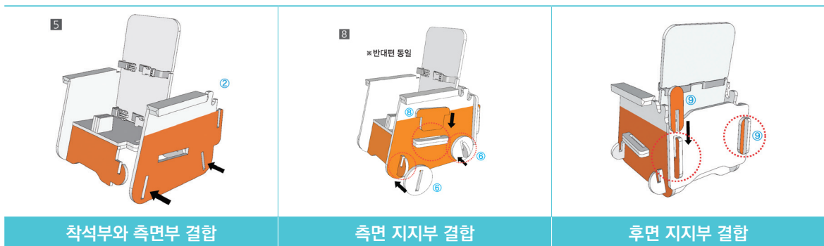
그림31. 1차 PROTOTYPE(착석 보조기기) 기구 조립
